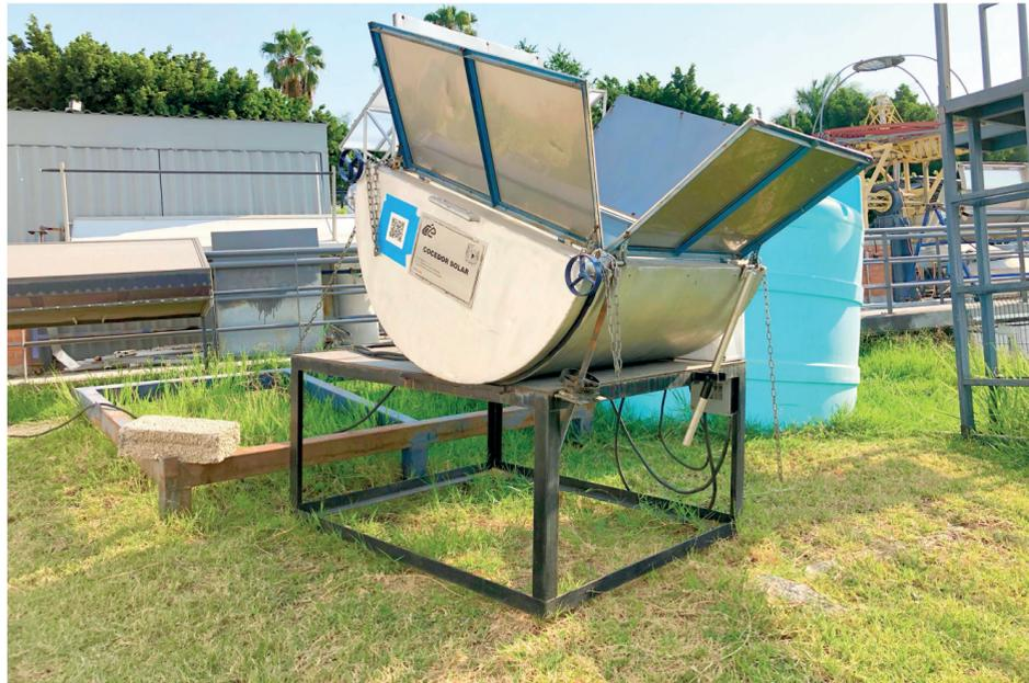
FIGURA 2. COCEDOR solar con respaldo eléctrico. Fotografía por Carolina Aguayo. IER-UNAM.
