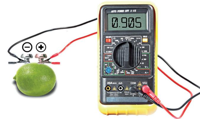
FIGURA 3 REPRESENTACIÓN gráfica de una batería orgánica y un multímetro.
