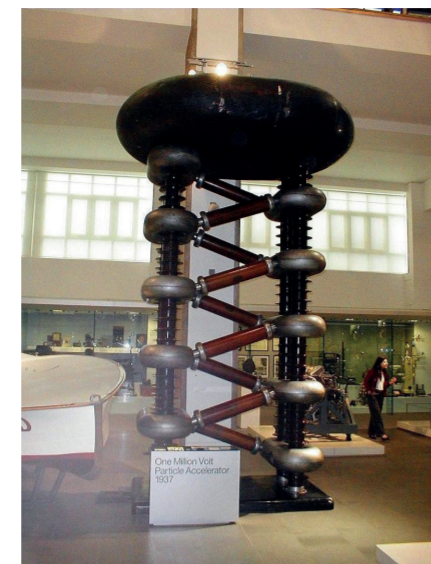
FIGURA 3. CIRCUITO multiplicador de voltaje diseñado por Cockroft y Walton. Tomado de https://bit.ly/47dK6tI
