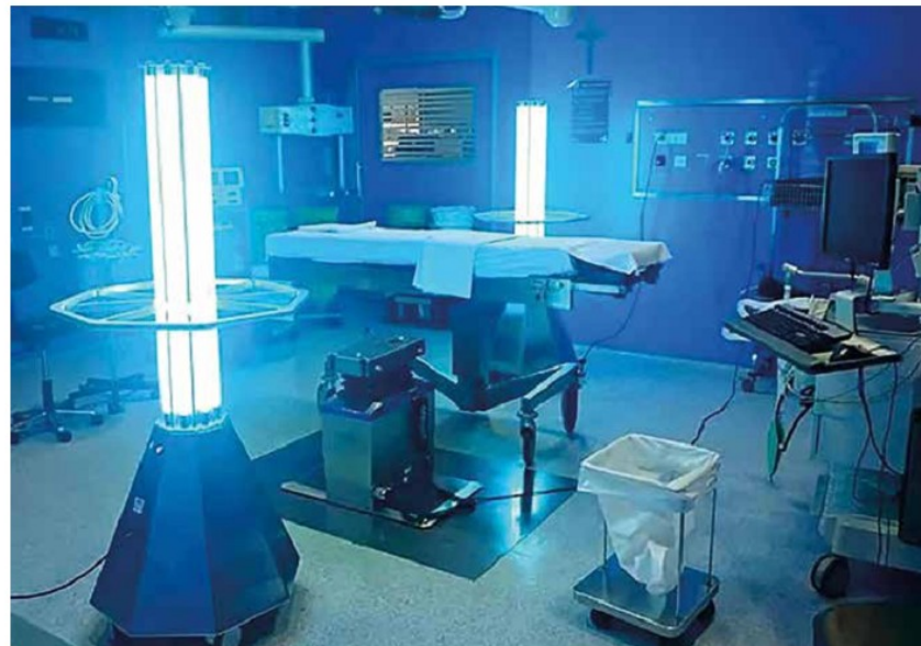
FIGURA 3. DOS máquinas UVR desinfectando un quirófano en la Clínica Universidad de Navarra. Tomada de https://www.elmundo.es/tecnologia/innovacion/2020/04/08/5e8b43ebfdddfbf158b45cf.html
