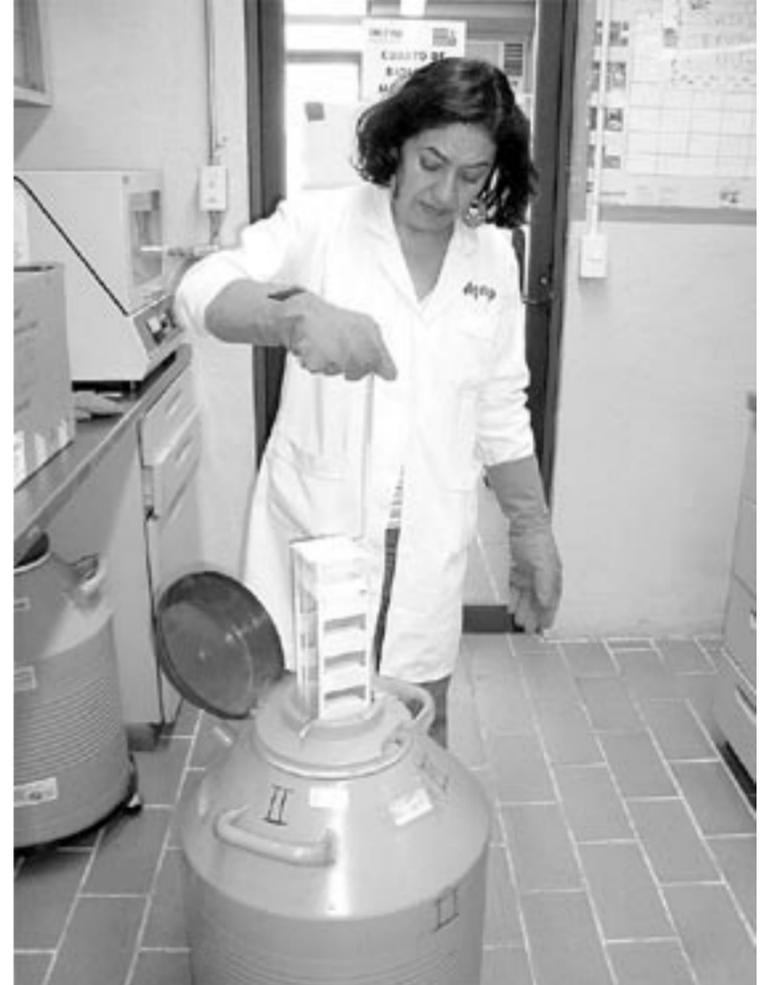
Aspecto del manejo de un cilindro de Nitrógeno Líquido para criopreservación de microorganismos.
