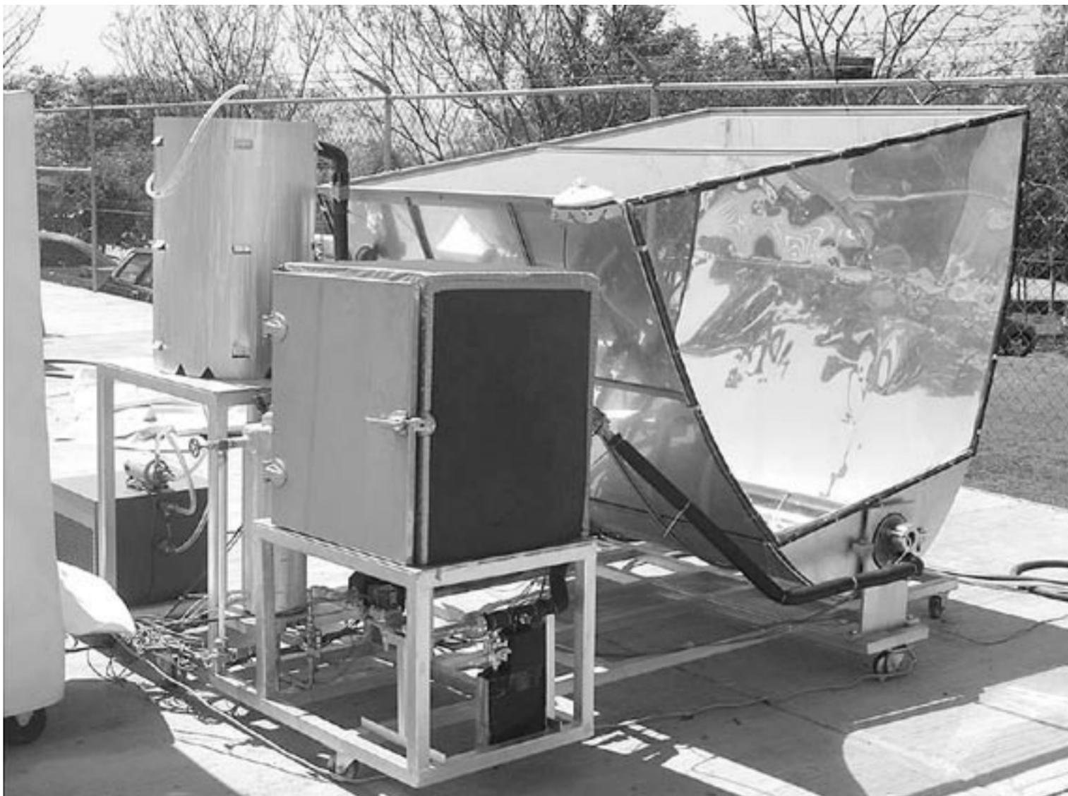
Figura 1. Refrigerador con concentrador solar sin partes móviles.
