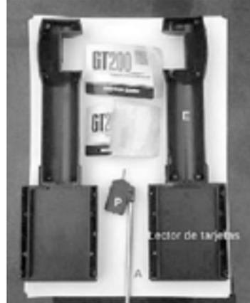
Detector molecular GT200 abierto, mostrando que en su interior no hay ningún mecanismo, circuito electrónico, generador electromagnético, sustancia química, dispositivo óptico, fuente de poder o parte alguna que pudiese permitirle detectar e identificar sustancias.
