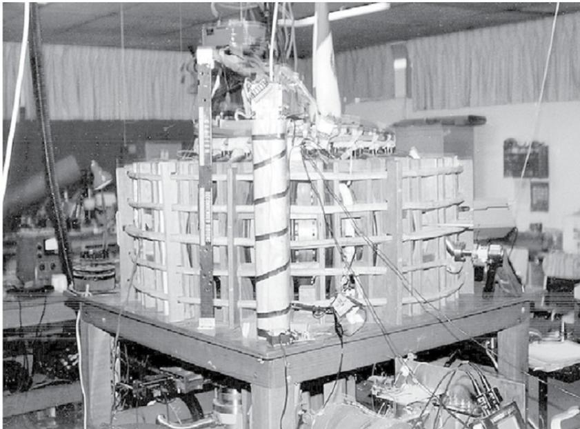
**Figura 2.** Reactor de fusión TPM-1 (tokamak prototipo mexicano 1). Construido en la ESIME-IPN. Actualmente se encuentra en el CICATA-Qro. Fuente: Vázquez, Mario. SOBRE LA INGENIERÍA DEL TOKAMAK Y LA FÍSICA DEL PLASMA. ESIME-IPN. Informe Interno. 2008.
