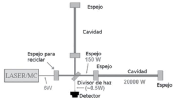
**Figura 3 Interferómetro del LIGO.** Se muestra el laser, el divisor de haz semirreflejante, las dos parejas de espejos que forman las dos cavidades Fabry-Perot de 4km de longitud en los brazos del interferómetro, el espejo para reciclar la energía que de otro modo regresaría al laser y el detector. No se muestra el modulador de fase. Se indican las potencias en las distintas partes del equipo. Adaptada de <http://slideplayer.com/slide/6600607/>
