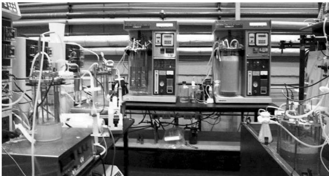
Batería de fermentadores de laboratorio, en donde se cultivan microorganismos.
