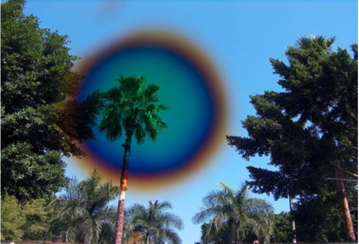
Figura 1. Dentro del círculo está la foto tomada con un filtro de silicio poroso. Observa que la imagen es ahí más nítida (Foto:CIE-UNAM).
